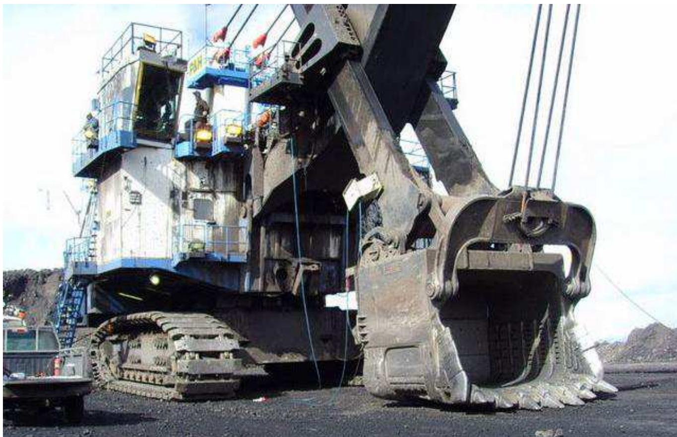
La superficie de sellado del tambor de izaje de una pala P&H 4100 de una mina ubicada 1000 km al sur de Lima se había gastado, y el aceite salía libremente de la caja reductora (y el polvo entraba ....). Por las dimensiones de la pieza (2.8 m de diámetro, 3.5 m de largo, 20 toneladas de peso), el trabajo tenía que ser hecho en sitio ...
